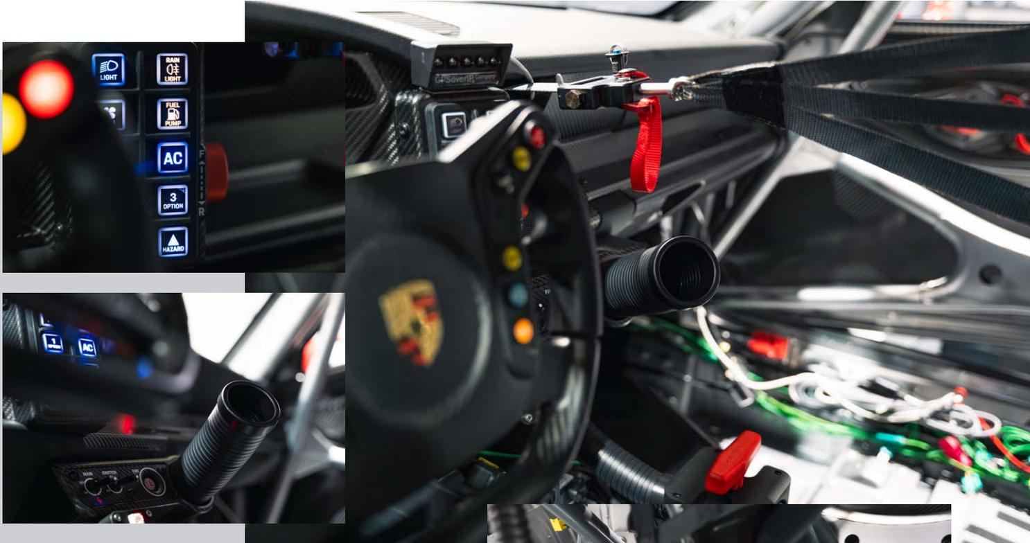
Die Klimaanlage für den Porsche 911 GT3 Cup (992) sorgt dafür, dass der Fahrer auch unter extremen Bedingungen einen kühlen Kopf bewahrt. Sie leitet kühle Luft in den Fahrzeuginnenraum und zu Helm und Sitz. So kann der Fahrer auch bei hohen Temperaturen seine volle Leistung bringen.
