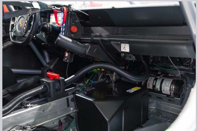
Die nachrüstbare Innenraumklimatisierung nutzt das bestehende Lüftungssystem, um durch temperierte und getrocknete Luftströmung die Fahrerperformance wesentlich zu steigern. Durch die intelligente Steuerung des Systems arbeitet dieses im Volllastbereich ohne Leistungsverlust. Mit der Helm- und Sitzkühlung können fahrerindividuell weitere Kühlmöglichkeiten geschaffen werden.
